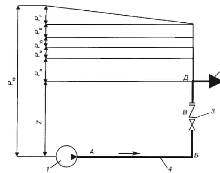
1 - водопитатель; 2 - ороситель; 3 - узел управления; 4 - подводящий трубопровод;  $P_f$  - потери давления на горизонтальном участке трубопровода АБ;  $P_v$  - потери давления на вертикальном участке трубопровода БД;  $P_m$  - потери давления в местных сопротивлениях (фасонных деталях Б и Д);  $P_{yy}$  - местные сопротивления в узле управления (сигнальном клапане, задвижках, затворах);  $P_o$  - давление у диктуемого оросителя;  $Z$  - пьезометрическое давление;  $P_{tp}$  - давление требуемое
